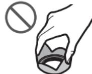
**1 Richten Sie die Markierung **(C)** an der kurzen Seite der Gegenlichtblende mit der Markierung am Rand des Objektivs aus.**
