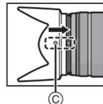
**2 Drehen Sie die Gegenlichtblende in Pfeilrichtung, bis sie stoppt, und richten Sie die Stop-Markierung **(D)** an der langen Seite der Gegenlichtblende mit der Markierung am Rand des Objektivs aus.**
