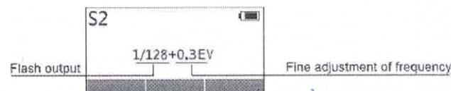
Der S2 Modus funktioniert genau wie der S1 Modus mit dem Unterschied, dass Messblitze vor dem Hauptblitz ignoriert werden. Wenn Sie mit dem S2 Modus keine überzeugenden Bilderergebnisse erzielen, so versuchen Sie es mit dem S1 Modus.
