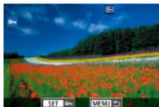
Bilder lassen sich entweder mit **[Key]** auf dem Einstellbildschirm oder mit **[Bilder schützen]** im **[▶]**-Menü schützen. **[Bilder schützen]** kann auf einzelne Bilder, eine Reihe von Bildern oder ganze Ordner oder Speicherkarten angewendet werden.
