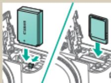
Einsetzen/Entnehmen des Akkus und der Speicherkarte
