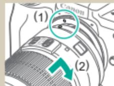
Anbringen eines EF- oder EF-S-Objektivs
