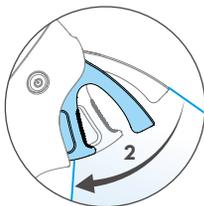
Drücke die Schubtaste bis zum zweiten Stopp, damit das Fluggerät in Richtung des Kreises fliegt, der in den Goggles angezeigt wird.
