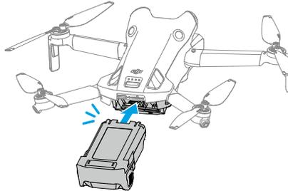
Drücke auf den strukturierten Teil der Akkuverriegelung an den Seiten des Akkus, um den Akku vom Akkufach zu entfernen.
