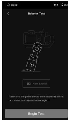
Tippe auf die Schaltfläche „Test starten“. Der DJI RSC 2 überprüft dann den Balancestatus und gibt für jede Achse eine Bewertung an. Achte darauf, dass der Gimbal vor der Durchführung der Balance-Prüfung in keiner Weise in seiner Bewegungsfreiheit beeinträchtigt ist und befolge die Anweisungen auf dem Bildschirm.
