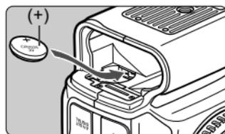
**5 Setzen Sie eine neue Speicherbatterie ein.**
