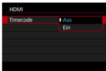
Timecodes können Movies hinzugefügt werden, wenn Sie sie über HDMI auf einem externen Gerät aufzeichnen.
