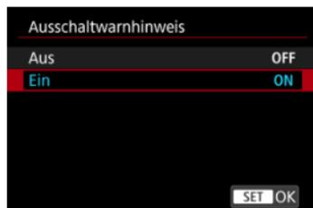
Beim Einschalten kann eine Abschaltwarnung (über die automatische Abschaltung während der Movie-Aufnahme aufgrund hoher interner Temperatur bei bestimmten Movie-Aufnahmeeinstellungen) angezeigt werden. Wenn Sie es vorziehen, keine Warnhinweise zum Herunterfahren anzuzeigen, stellen Sie [CAMERA]: **Ausschaltwarnhinweis**] auf [Aus] ein.
