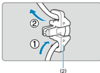
Führen Sie das Kabel wie abgebildet durch die Klemme (2), und befestigen Sie die Klemme am Kabelschutz.
