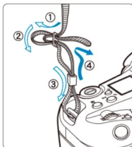
Führen Sie das Ende des Riemen von unten durch die Tragegurthalterung und dann wie gezeigt durch die Riemenschnalle. Ziehen Sie den Tragegurt straff, damit er sich nicht aus der Öse löst.
