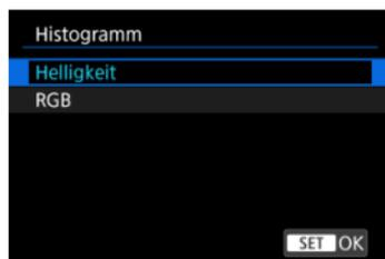
Die Histogramme zeigen die Signalpegel über den Tonbereich. Es stehen eine Helligkeitsanzeige (zur Überprüfung der allgemeinen Belichtungsstufe und der gesamten Gradation) und eine RGB-Anzeige (zur Überprüfung der Farbsättigung und Gradation von Rot, Grün und Blau) zur Verfügung. Sie können das angezeigte Histogramm wechseln, indem Sie die Taste < INFO > drücken, wenn [INFO] links unten im Bildschirm [▶]: **Auf d. Infobildschirm wiedergeb.**] angezeigt wird.
