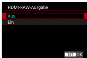
Nutzen Sie die Einstellung **[Ein]** für die Ausgabe von RAW-Movies mit Auflösungen bis zu 6K über den HDMI-Anschluss an kompatible Geräte.
