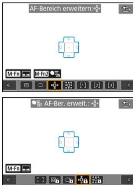
Fokussiert mit einem AF-Messfeld [] und dem hier blau umrandeten AF-Bereich. Dies ist nützlich bei beweglichen Motiven, die mit Einzelfeld AF schwer zu verfolgen sind. Die Fokussierung auf Ihr bevorzugtes Motiv ist einfacher als mit der flexiblen AF-Messfeldwahl in Zone.
