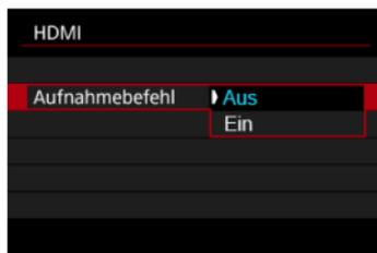
Bei Verwendung eines HDMI-Videoausgangs und Aufnahmen mit externem Gerät können Sie die Aufnahme synchronisieren, wenn Sie Movie-Aufnahmen auf der Kamera starten und beenden.
