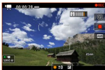
[**REC**] blinkt rot, wenn Sie die Aufnahme fortsetzen, nachdem die orangefarbene Anzeige die Stufe 9 erreicht hat. Ein blinkendes Symbol zeigt an, dass sich die Kamera bald automatisch ausschalten wird.
