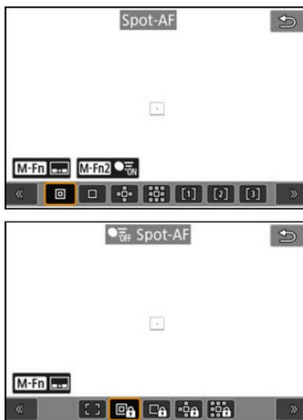
Die Kamera fokussiert in einem kleineren Bereich als Einzelfeld AF.
