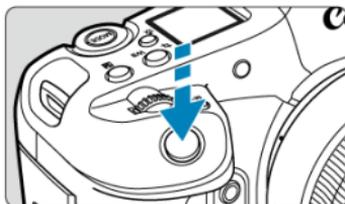
Der Verschluss wird ausgelöst, und das Bild wird aufgenommen.
