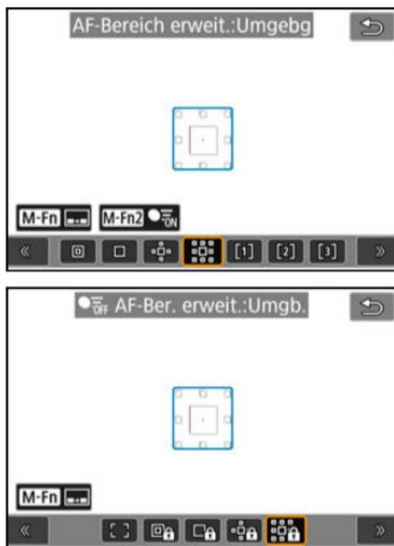
Fokussiert mit einem AF-Messfeld [□] und dem hier blau umgebenden AF-Bereich, wodurch sich bewegliche Motive leichter fokussieren lassen als mit der AF-Bereich-Erweiterung: ☰.
