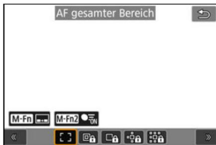
Die automatische AF-Messfeldwahl im Rahmen des Bereichs AF deckt einen größeren Bereich ab als die flexible AF-Messfeldwahl in Zone, was die Fokussierung im Vergleich zum 1-Messfeld-AF/Erweiterung des AF-Bereichs /flexible AF-Messfeldwahl in Zone, erleichtert und bei beweglichen Motiven sehr effektiv ist.
