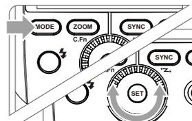
**1** Drücken Sie die < MODE >-Taste, so dass < M > angezeigt wird.
