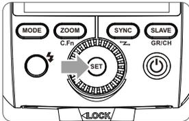
**1** Drücken Sie die SET-Taste und der Wert der Blitzbelichtungskorrektur wird auf dem LCD-Display hervorgehoben.
