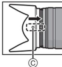
2 Gire la visera de la lente en la dirección de la flecha hasta que haga clic y luego alinee la marca de tope (D) del pétalo más largo de la visera de la lente con la marca del extremo de la lente.
