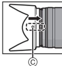
2 Drehen Sie die Gegenlichtblende in Pfeilrichtung, bis ein Klicken zu hören ist, und richten Sie die Stop-Markierung **(D)**, die sich am langen Blatt der Gegenlichtblende befindet, an der Markierung am Rand des Objektivs aus.
