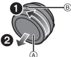
**2 Alignez les repères pour la mise en place de l'objectif Ⓑ (marques rouges) sur le boîtier de l'appareil photo et sur l'objectif, puis tournez l'objectif dans le sens de la flèche jusqu'à ce que vous entendiez un déclic.**
