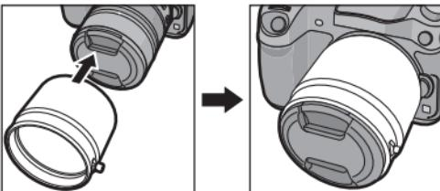
**3 Поверните винт бленды объектива в направлении, указанном стрелкой, чтобы надежно закрепить бленду объектива.**
