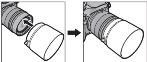
2 朝箭頭指示的方向轉動鏡頭遮光罩螺絲牢牢地固定住鏡頭遮光罩。
