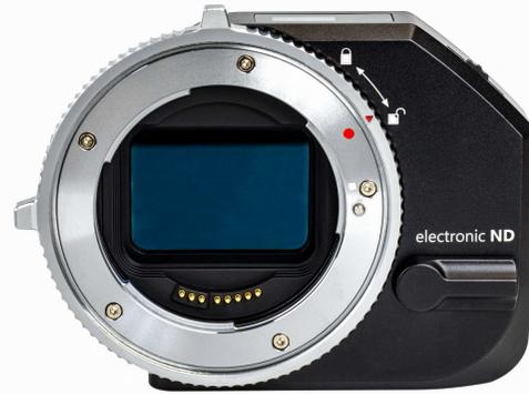
Eingebauter elektronischer ND-Filter
