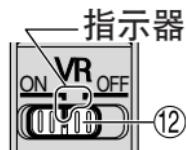
2 轻按快门释放按钮时，震动被减弱。由于取景器中的震动减少，自动/手动对焦及对拍摄对象取景构图都变得较容易。
