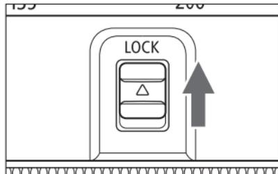
**2** Schieben Sie die Zoom-Ring-Verriegelung in die durch den Pfeil angezeigte Richtung.
