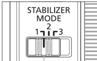
Image Stabilizer (Bildstabilisator)-Modusauswahlschalter
