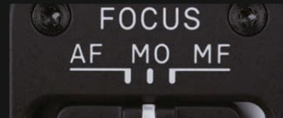
Dem AF/MF-Schalter wurde die MO-Schalterstellung (Manual-Override) als eine zusätzliche Option für die Fokussierbetriebsart hinzugefügt. Steht der Schalter auf der MO-Position, führt das Drehen am Fokusring sogar im Schärfenachführungs-AF-Modus zum manuellen Fokus. In der AF-Position ist die Standardeinstellung für Jederzeit-MF aktiv. Mit dem SIGMA USB-DOCK (optional erhältlich) können Sie die Drehempfindlichkeit für den MO-Modus ganz bequem, nach Belieben einstellen.
