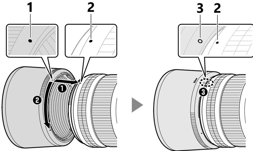
**1** Markierung für die Ausrichtung der Gegenlichtblende
