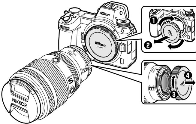
2. Bringen Sie die Ausrichtungsmarkierung am Objektiv und die Ausrichtungsmarkierung am Kameragehäuse (1) in Übereinstimmung, setzen Sie das Objektiv in das Kamerabajonett ein und drehen Sie das Objektiv in die gezeigte Richtung (2), bis es einrastet.
