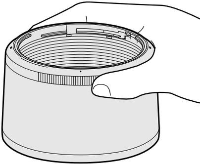
Greifen Sie mit Zeigefinger und Daumen um die Gegenlichtblende und drehen Sie die Blende vorsichtig an der geriffelten Oberfläche, bis sie in der umgekehrten Position einrastet.
