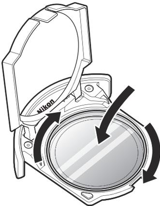
Möglicherweise lassen sich manche Filter aufgrund ihrer Form nicht mit dem Einsteckfilterhalter benutzen. Verwenden Sie Filter, die in den Halter passen.
