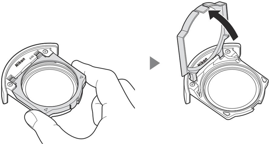
**3. Setzen Sie ein 46-mm-Einschraubfilter ein.**
