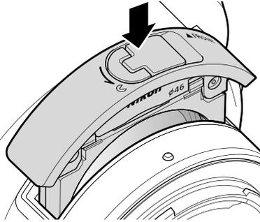
Setzen Sie den Halter so ein, dass die mit "FRONT" beschriftete Seite nach vorne zeigt (zum Fokussiering hin).
