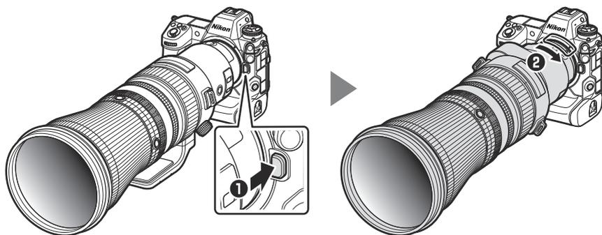
**✓ Wenn das Objektiv auf einem Stativ montiert ist: Abnehmen des Kameragehäuses**
