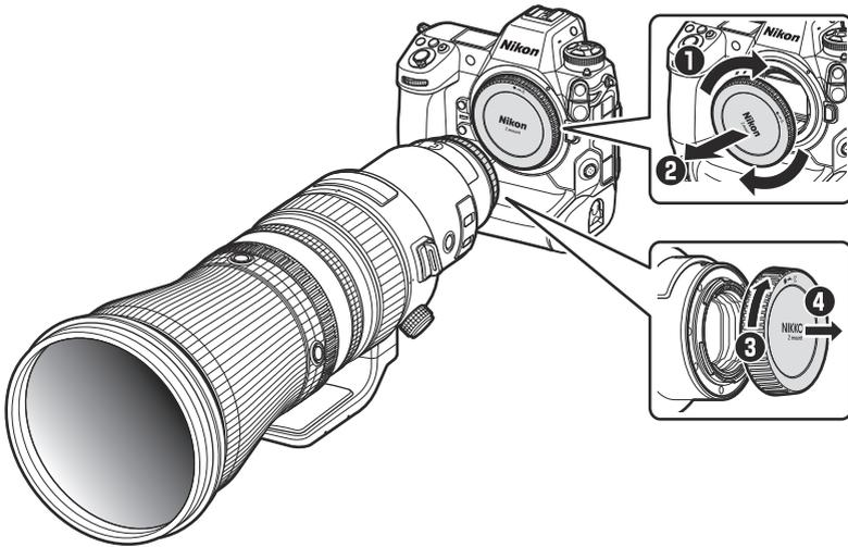
2. Bringen Sie die Ausrichtungsmarkierungen an Objektiv und Kameragehäuse in Übereinstimmung (1), setzen Sie das Objektiv in das Kamerabajonett ein und drehen Sie das Objektiv in der gezeigten Richtung (2), bis es einrastet.
