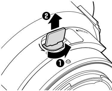
**2. Drücken Sie beiderseits auf die Punkte ▽ des Einsteckfilterhalters und öffnen Sie den Rahmen.**
