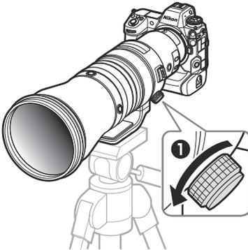
**2. Drehen Sie die Kamera und orientieren Sie sich dabei an den Positionsmarkierungen (2).**
