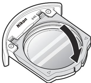
5. Drehen Sie den Einsteckfilterhalter-Griff wie gezeigt (1) und klappen Sie ihn wieder in die Ausgangsposition herunter (2).
