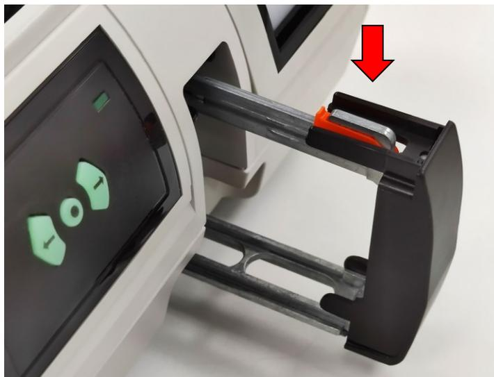
Schieben Sie das Diagemagazin von der linken Seite in den Scanner ein, bis es den Diatransportarm berührt und das Magazin „einrastet“.
