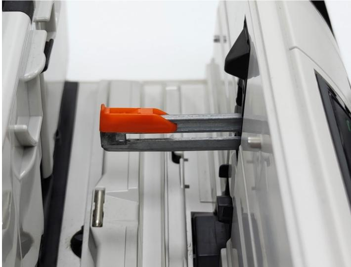
Für die Verwendung aller anderen **Magazintypen wie Paximat, CS oder LKM**, muss der orangefarbene Adapter auf die Basis des Transportarms in der Nähe des Griffs geschoben werden.
