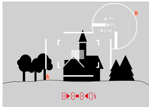
Alle Aufnahmen und Leuchtrahmen-Positionen bezogen auf 50 mm Brennweite
