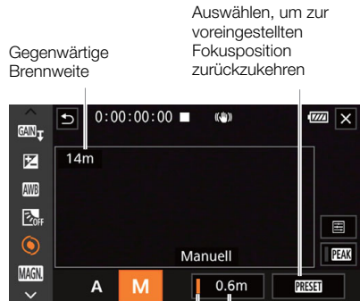
Taste für die Voreingestellte Fokusvoreinstellung Fokusposition (orange: voreingestellter Fokus aktiviert)
